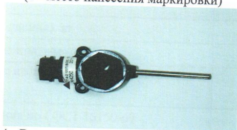
Рисунок 4 - Внешний вид термопреобразователя ТМТ-4-2 (1 - место нанесения маркировки)
